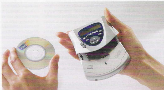
Попытка перейти на использование оптических дисков диаметром 80 мм не увенчалась успехом. На фото — портативный аудиопроигрыватель Imation RipGO!
